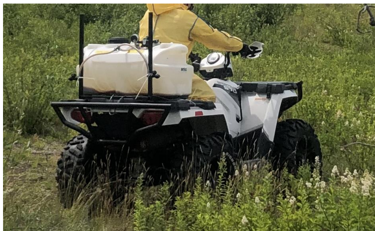
Figure 1. Pulvérisateur modifié pour les applications de GF-120
