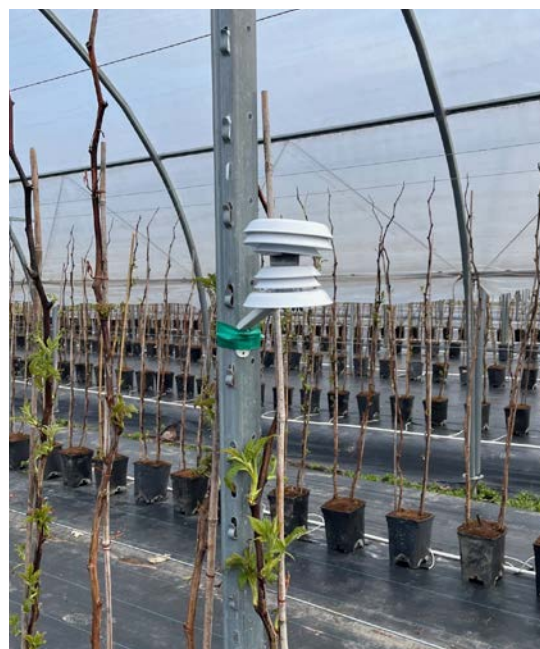
Figure 1. Un capteur de température installé sous un tunnel de production de framboises longues cannes.
