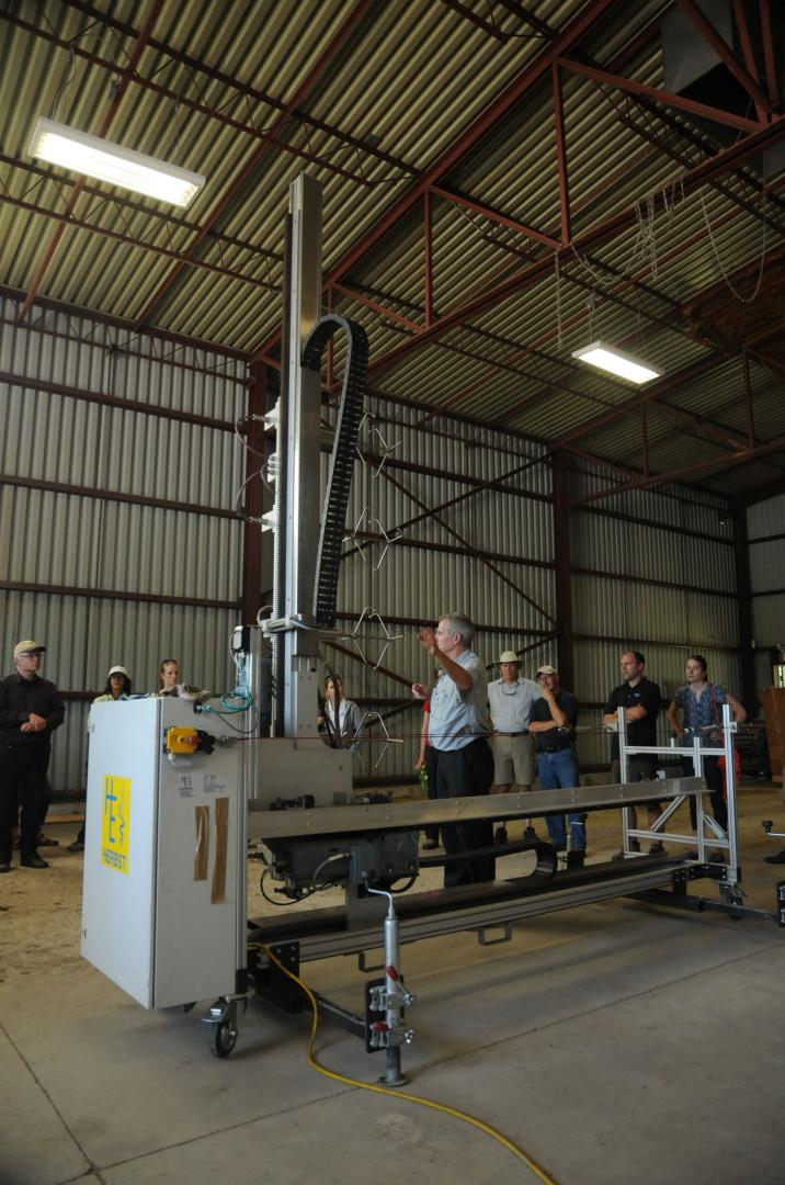
Machine dotée d'anémomètres qui permet de certifier un pulvérisateur à la norme « Aircheck », s'il respecte les normes quant à sa capacité à souffler uniformément et à la vitesse requise
