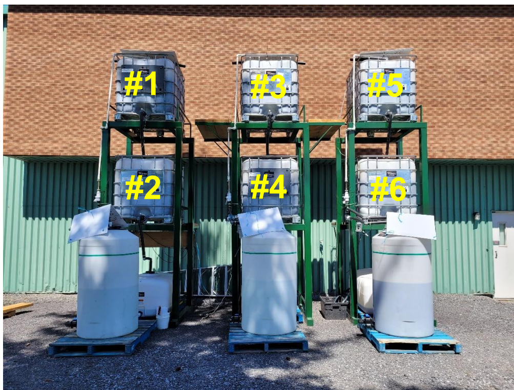
Figure 1 : Disposition des 3 biofiltres composés de 2 cuves superposées, simulant 1 (à gauche – cuves 1 et 2), 2 (au centre – cuves 3 et 4) et 3 (à droite – cuves 5 et 6) rinçages. La ligne verte sur les réservoirs verticaux en premier plan correspond à un volume de 600 L.
