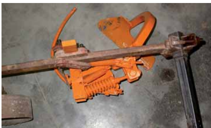
Lame sarcleuse Humus Hugg avec dispositif d'effacement mécanique
