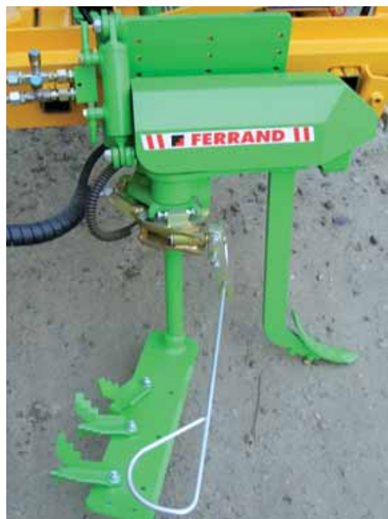
Lame intercep Ferrand avec ailettes de fragmentation et contrôle dévers
