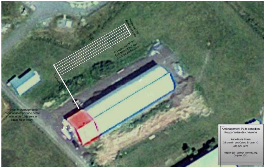
Figure 2 Aménagement d'un puits canadien pour la ventilation de la pouponnière de la chèvrerie. L'emplacement du réseau a été fait en sol schisteux à une profondeur moyenne de 2 m.
