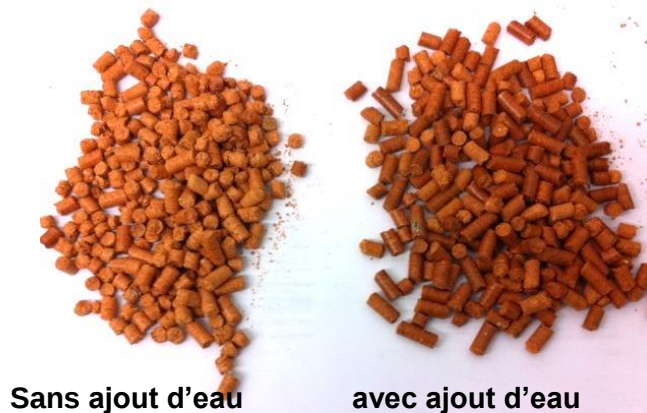
Figure 17. Granules de carottes pressées (FS sèche) avec et sans ajout d'eau lors de la granulation.
