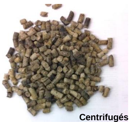
Figure 19. Granules de pommes de terre pressées et centrifugées (FS sèches) sans ajout d'eau lors de la granulation.
