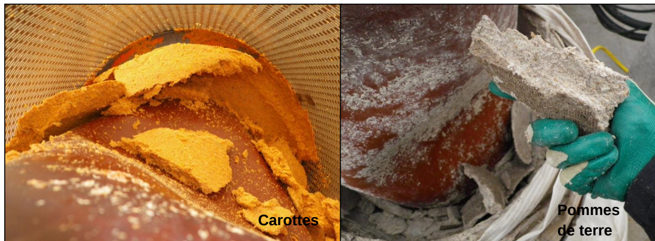
Figure 14. Fraction solide de carottes et de pommes de terre à l'intérieur du presseur à la fin de la période de pressage.
