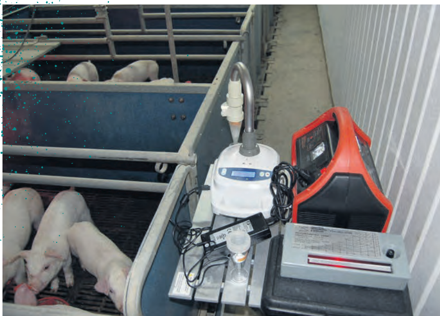
Un appareillage sophistiqué permet de mesurer la présence des bactéries et d'autres particules présentes dans l'air des bâtiments d'élevage.
