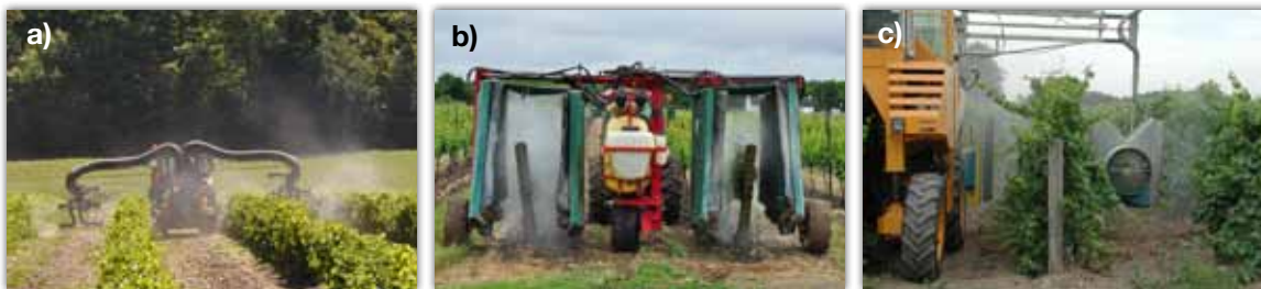
Fig. 60. Épandage de pesticides en vignobles: a) pulvérisateur pneumatique au Québec, b) pulvérisateur récupérateur en Ontario (Photo Queen's Printer for Ontario 2015. Reproduced with permission); et c) pulvérisateur pneumatique en Ontario (Photo Wendy McFadden-Smith).
