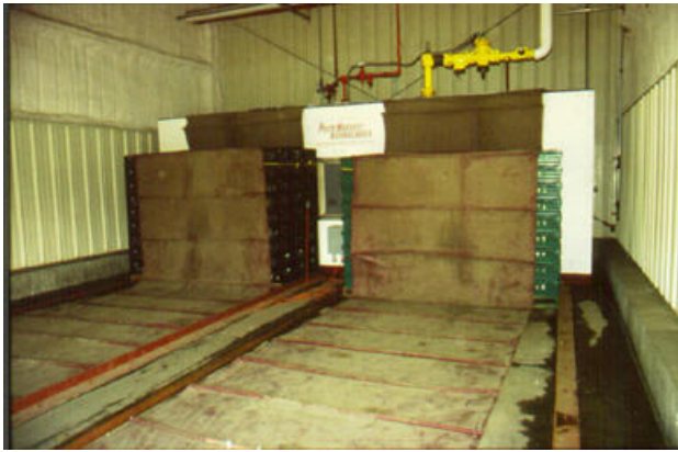
Figure 8. Deux tunnels de refroidissement par air pulsé, utilisés côte à côte pour refroidir des choux-fleurs dans le cadre d'un travail de recherche ayant pour objet de comparer des contenants en plastique pliables, à côtés verticaux (à gauche) avec des contenants à côtés obliques, em-boîtables (à droite). L'air est porté naturellement à passer par les espaces laissés entre les côtés obliques. Noter la présence des tiges rigides intégrées à la bâche pour l'empêcher d'être aspirée dans le tunnel quand il est en marche.
