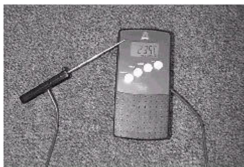
Figure 10. Une sonde de température manuelle, portable, à lecture numérique, est l'outil indispensable pour déterminer la température des fruits et des légumes à leur arrivée dans l'installation et à la fin du refroidissement.
