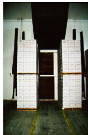
Figure 2. Tunnel formé par des palettes de fruits ou de légumes placées contre une installation constituée d'un ventilateur et d'un conduit. La bâche qui recouvre le tunnel force l'air à circuler dans le sens perpendiculaire à la longueur du tunnel et à travers les côtés des contenants.
