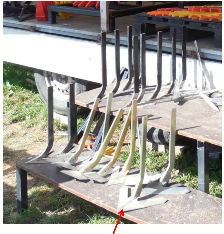
Un soc plat pour scalper en surface et ne pas bouleverser le sol.
