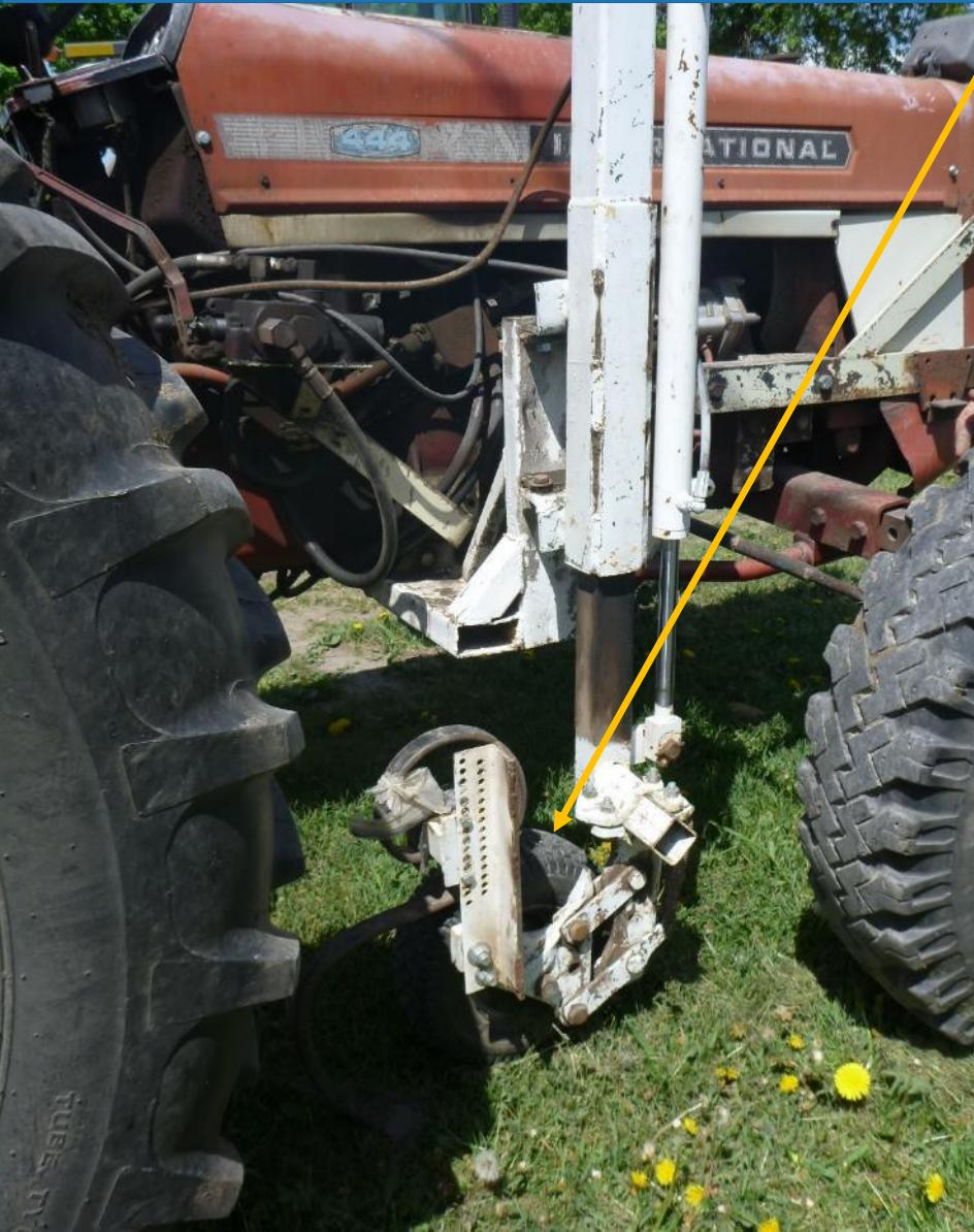
Pneu contrôle la profondeur –frôle le plastique
