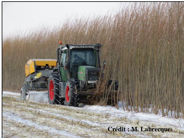
Figure 10. Le Biobaler à l'œuvre dans une plantation de saules à Varennes, Québec.
