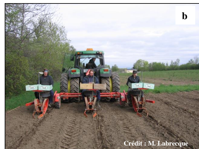
Figure 4. a) Step planter utilisé pour les grandes productions de saules, notamment en Suède. b) Planteuse à fraisières adaptée pour la plantation de boutures de saule.
