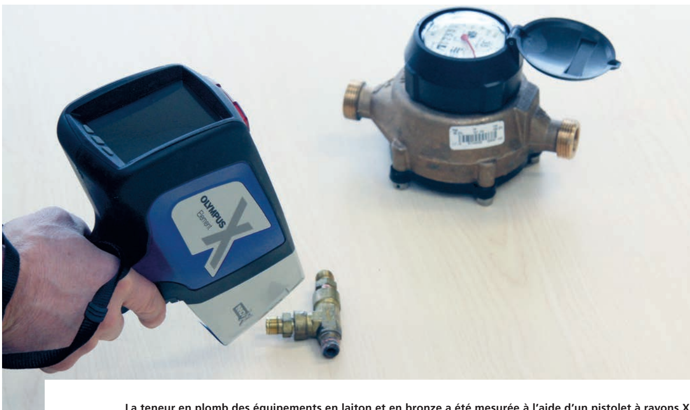
La teneur en plomb des équipements en laiton et en bronze a été mesurée à l'aide d'un pistolet à rayons X.
