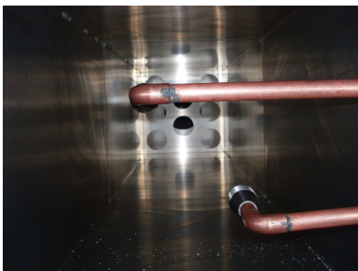
Sondes d'échantillonnage dans la plateforme d'essai. Source: Centre de développement du porc du Québec
