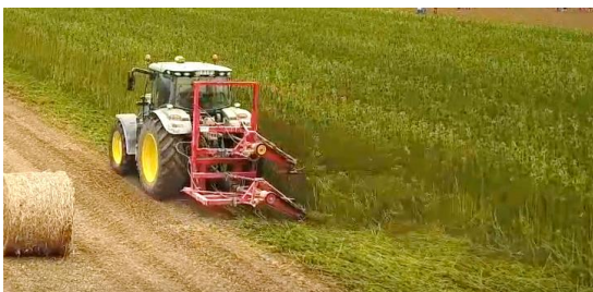
Figure 12-4. Système de moulin à faucher double, en opération. Conception artisanale.
