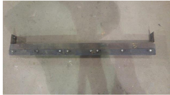
Figure 11-9. Couteau stationnaire pour le tire-paille – vue de dessus.
