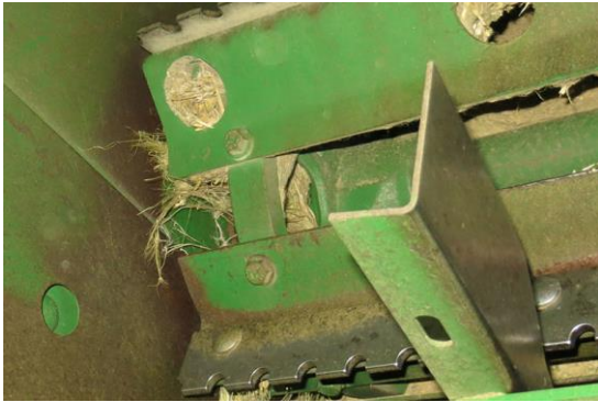
Figure 11-11. Enroulement aux extrémités du tire-paille, sans racloirs.
