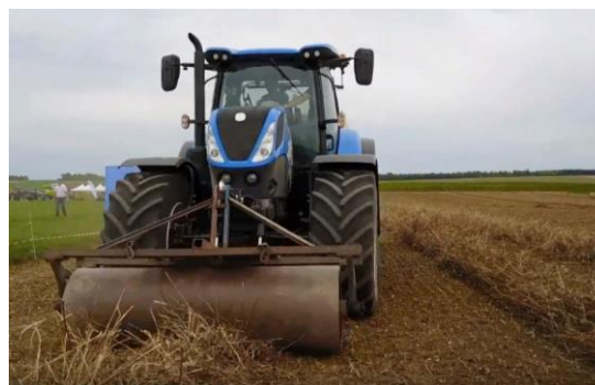
Figure 12-9. Rouleau installé à l'avant du tracteur qui opère également la presse.
