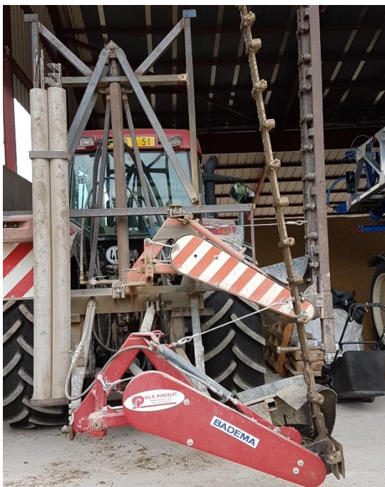
Figure 12-3. Système de moulin à faucher déporté, en position relevée.
