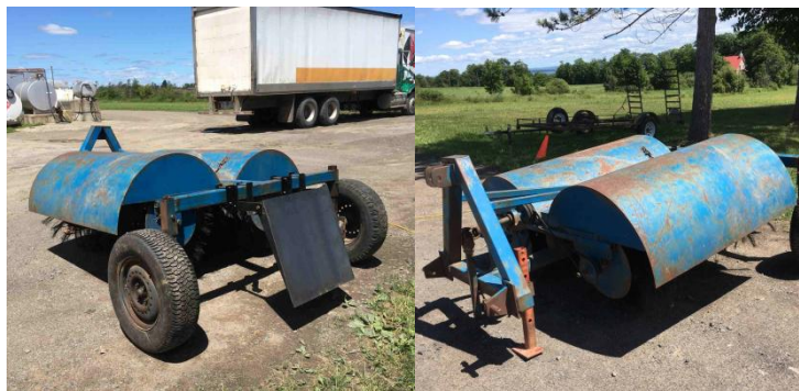
Figure 3. Photos du prototype de brosse-rouleau avec l'ajout d'un brûleur au propane à l'arrière (Thibault, 2018).
