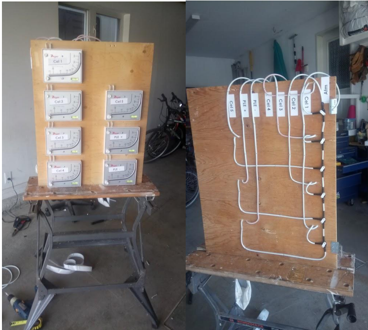
Figure 4 : Panneau de contrôle des 7 manomètres installés dans le plénum commun positif, dont 5 permettent de déterminer le débit volumétrique spécifique à chacune des cellules.
