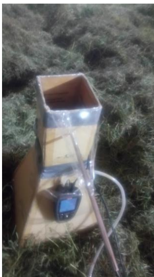
Figure 6 : A) Anémomètre à fil chauffant avec cône de mesure; B) plan d'échantillonnage de la cellule # 2
