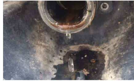
Photo 6 : Débit à la sortie du système de traitement à 0,4 litre/minute
