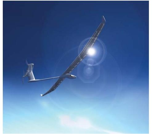
voltaiques prendront environ quatre heures à recharger les batteries qui assureront l'autonomie de vol. L'avion aura une vitesse de croisière de 100 km/h lorsqu'il volera à son altitude maximale de 12 000 m. Cette vitesse sera réduite de moitié et l'avion volera à basse altitude en fin de nuit alors que ses réserves d'énergie sont plus faibles.
