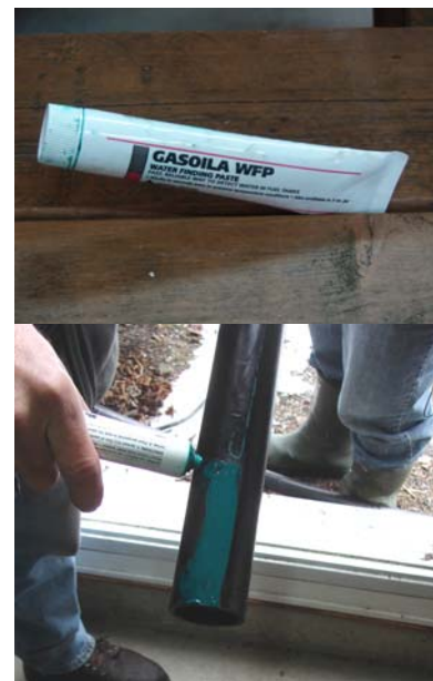
Figure 36 Pâte pour tester la présence d'eau dans l'huile
