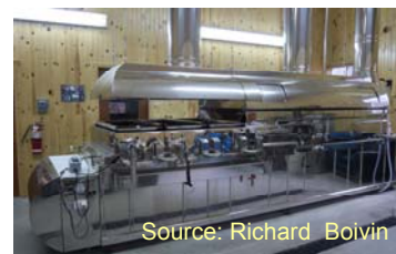
Figure 4 Évaporateur récent: système dynamique
