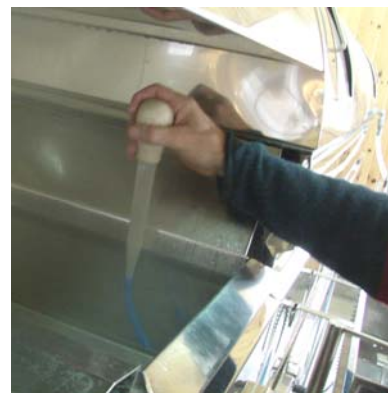
Figure 33 Échantillonneur de solution dans évaporateur
