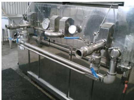
Figure 11 Inverseur de coulée pour la panne à fond plat
