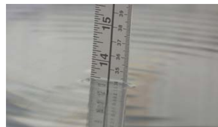
Figure 13 Règle pour mesurer volume d'eau qui alimente l'évaporateur
