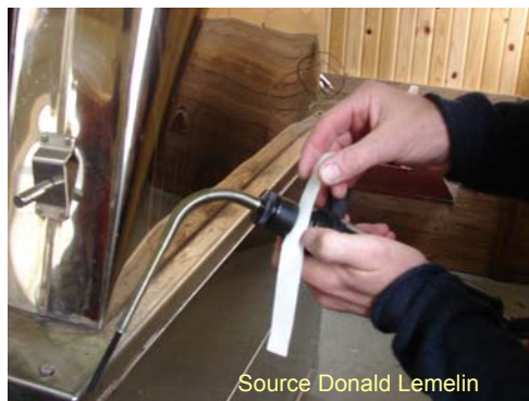
Figure 26 Appareil pour test de fumée
