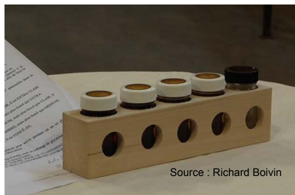
Figure 16 : Colorimètre à bouteilles est un des instruments qui aide au classement du sirop à la ferme
