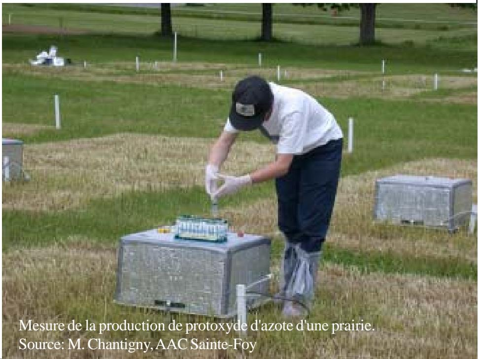
Mesure de la production de protoxyde d'azote d'une prairie.
