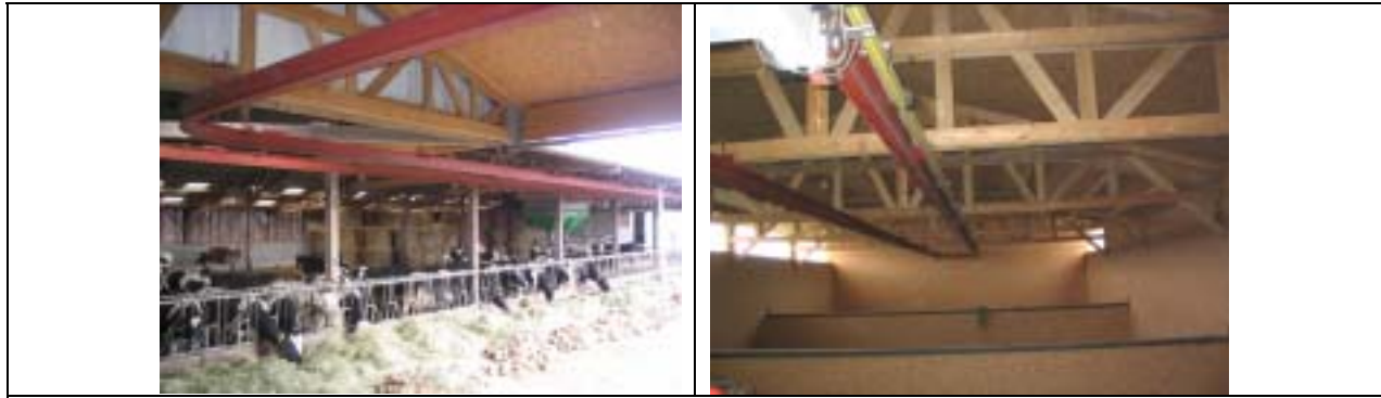
Figure 6. Les rails de la griffe permettent le déplacement de celle-ci au dessus de l'étable et du séchoir.
