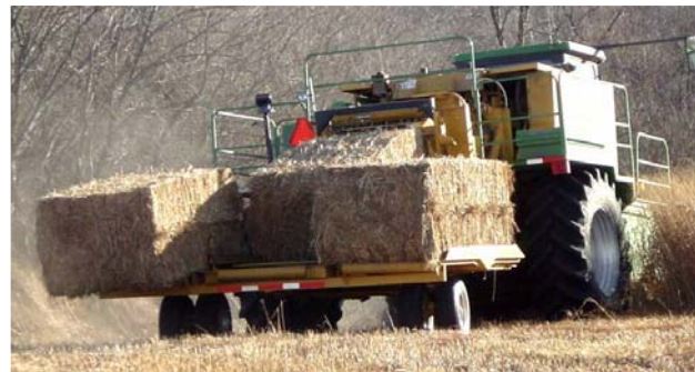
Figure 6. Moissonneuse-batteuse modifiée pour récolter simultanément le maïs-grain et les résidus sous forme non-hachée en balles.
