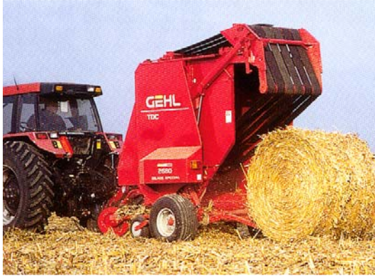
Figure 3. Ramassage des andains de résidus de maïs avec une presse à balles rondes.
