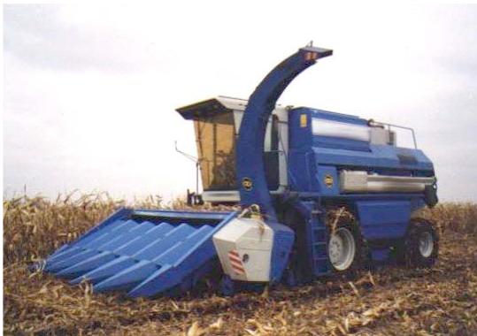
Figure 5. Moissonneuse-batteuse modifiée pour récolter simultanément le maïs-grain et les résidus hachés en seul passage.
