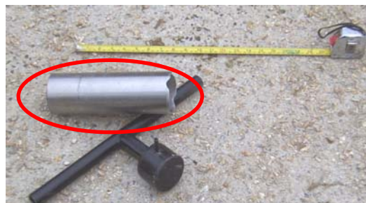
Figure 2. Tarière utilisée pour l'échantillonnage du silo (encerclée)
