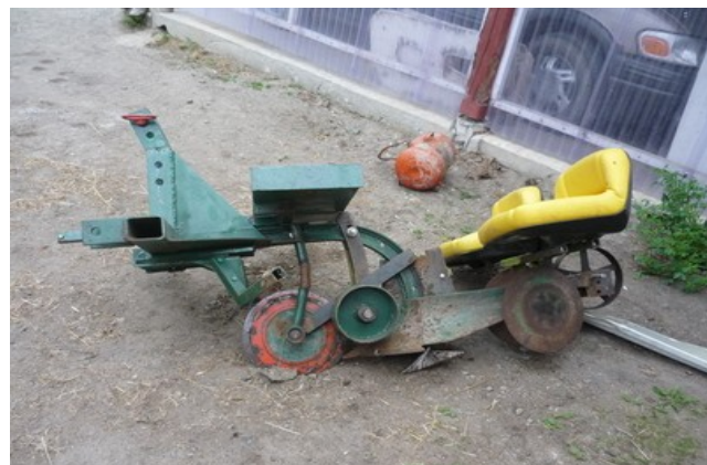
Figure 10: Vue du transplanteur montrant les modifications y ayant été apportées pour qu'il effectue un travail de sol simultanément à la transplantation.
