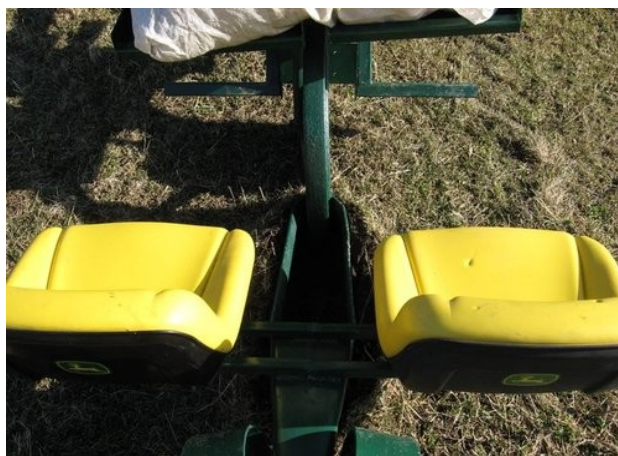
Figure 4: Deux personnes peuvent s'asseoir sur le transplanter conçu spécialement pour le trèfle kura. Un double versoir ouvre un sillon et les rhizomes sont déposés dans l'espace situés entre les deux sièges (John Deere!).
