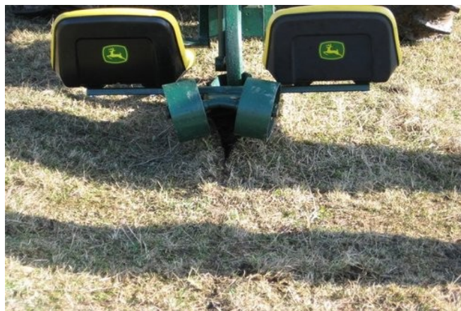
Figure 6: Deux roues de métal situées à l'arrière du transplanteur referment le sillon.
