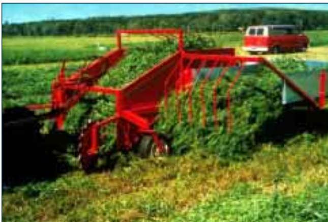
Figure 20. Le retourneur d'andain manipule le foin délicatement et peut améliorer le séchage au champ.
