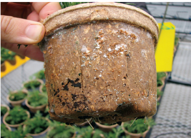
Exemple de moisissures sur les pots Napac Nature Pots. Example of mould on Napac Nature pots. 5
