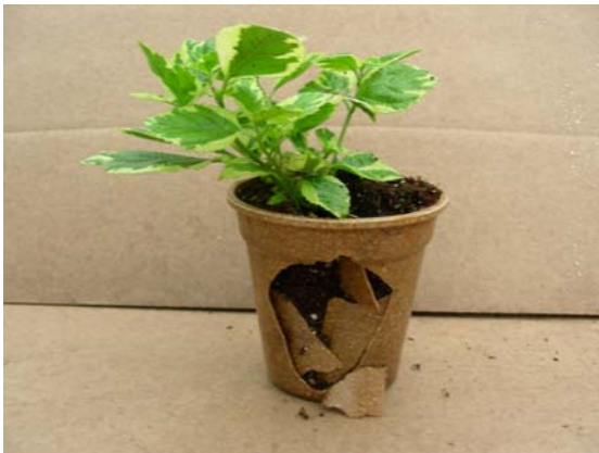
Photo 9. Aspect d'un Vipots brisé lors de la manipulation.
