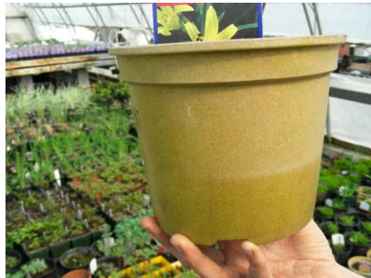
Photo 10. Vivace empotée en Vipots au printemps 2007, hivernée et remise en croissance en 2008. Le pot est encore très rigide, mais présente une décoloration causée par le soleil
