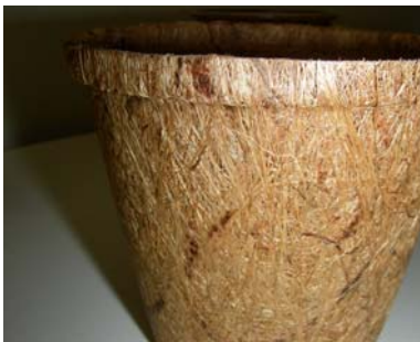
Photo 3. Surface du pot ITML fibres de coco. Les fibres sont apparentes et la surface moins lisse.
