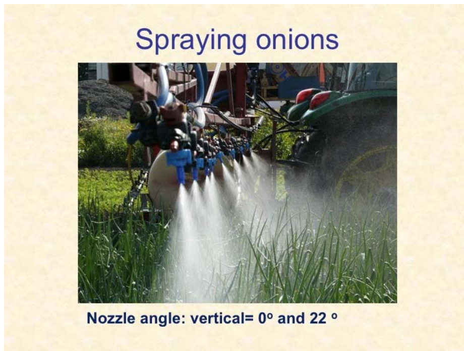
Figure 3 : Jets balais avec un angle de pulvérisation de 0° (vertical standard) et un angle de 22° vers l'avant (Source : Jennifer Allen).
