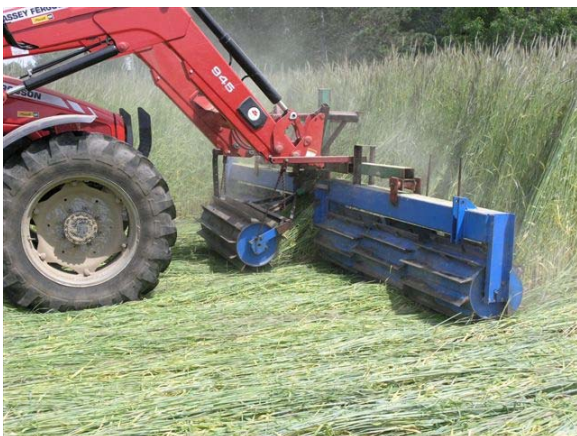
Le passage du rouleau-crêpeur, qu'il soit attaché à l'avant ou derrière le tracteur donne un paillis uniforme
