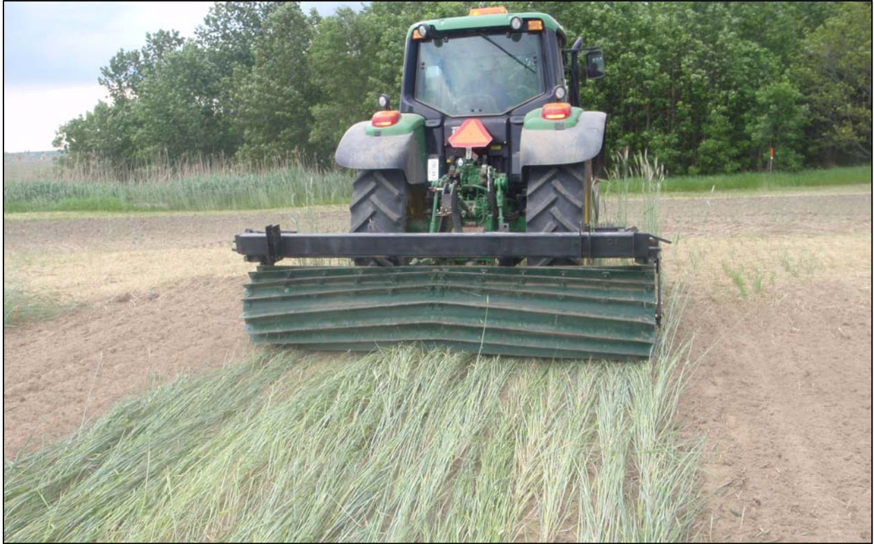
Photo du rouleau-crêpeur de l'IRDA utilisé dans le cadre de l'essai en 2010.
