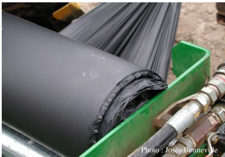
Rouleau de paillis biodégradable BIONOV mal enroulé sur la bobine. Défectuosité rapportée au vendeur qui l'a retransmise au fabricant BARBIER, en France, et ne devrait plus se reproduire
