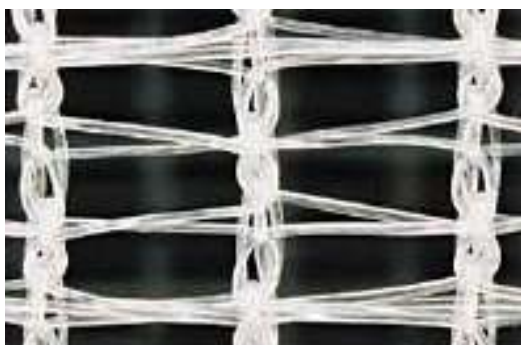
Figure 5. Econet T; filet tricoté fait à partir de polyéthylène et d'acrylique (Mihok 2007)
