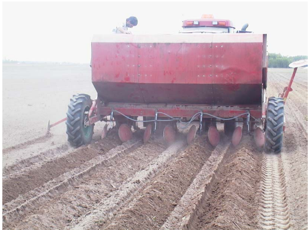
Figure 6 : Système d'application d'herbicide en bandes à 3 buses sur les unités de plantation
