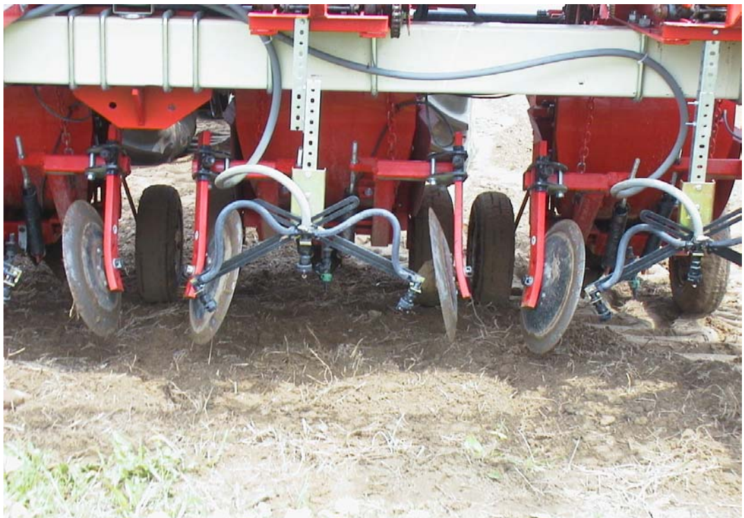
Figure 6 : Système d'application d'herbicide en bandes à 3 buses sur les unités de plantation
