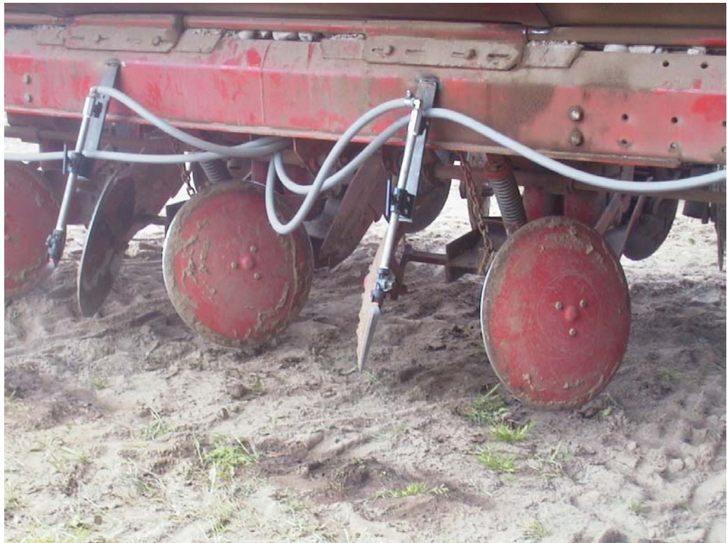
Figure 4 : Système d'application d'herbicide en bandes à une buse sur l'unité de plantation
