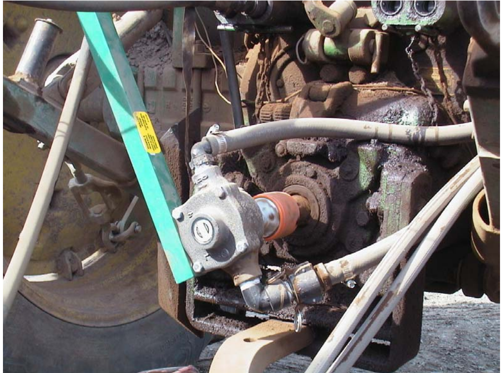
Figure 4 : Système d'application d'herbicide en bandes à une buse sur l'unité de plantation
