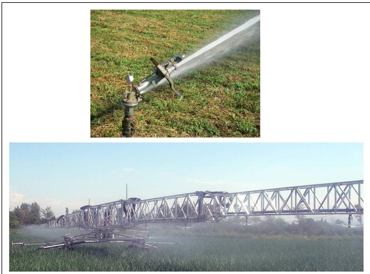
Figure 1 : Photos des deux équipements utilisés pour les traitements (haut de la photo : canon Nelson P100 et rampe mobile de Harnois au bas de la photo)
