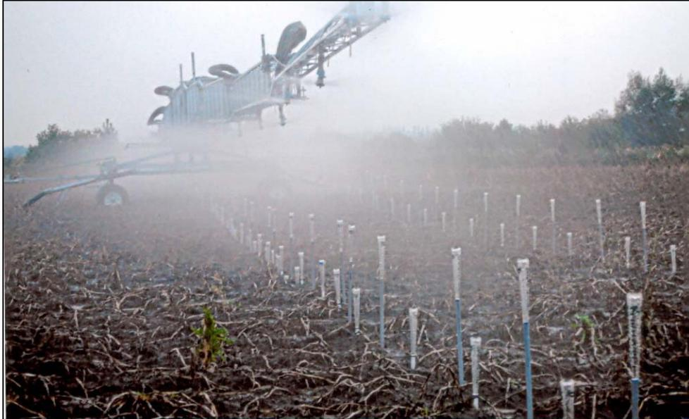
Figure 4 : Dispositif pour évaluer l'uniformité d'application de la rampe sur la largeur du champ
