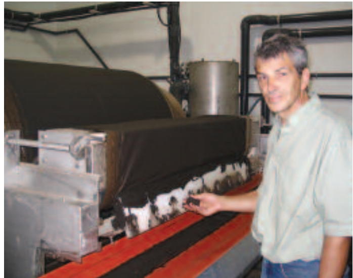
Après épuration dans le bioréacteur, la fraction liquide est à nouveau filtrée par ce tambour à membrane absorbante qui gardera à sa surface une pâte quasi inodore.
