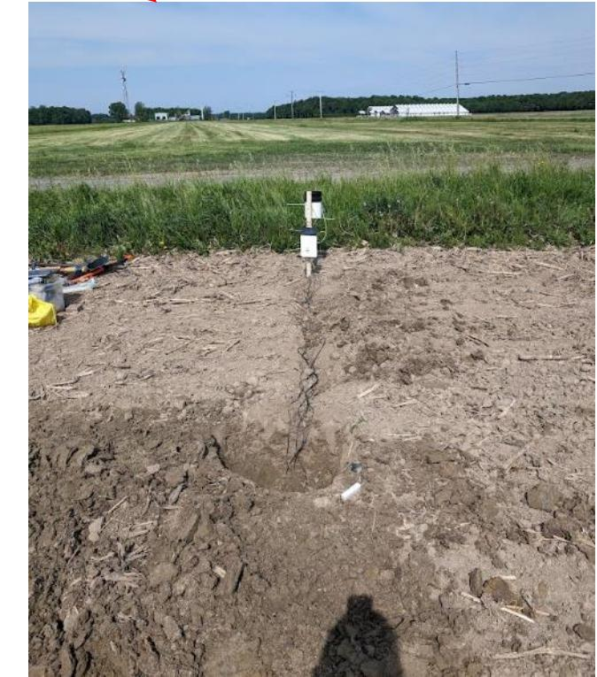
Station de mesures (humidité et température du sol, précipitation) en continu.
