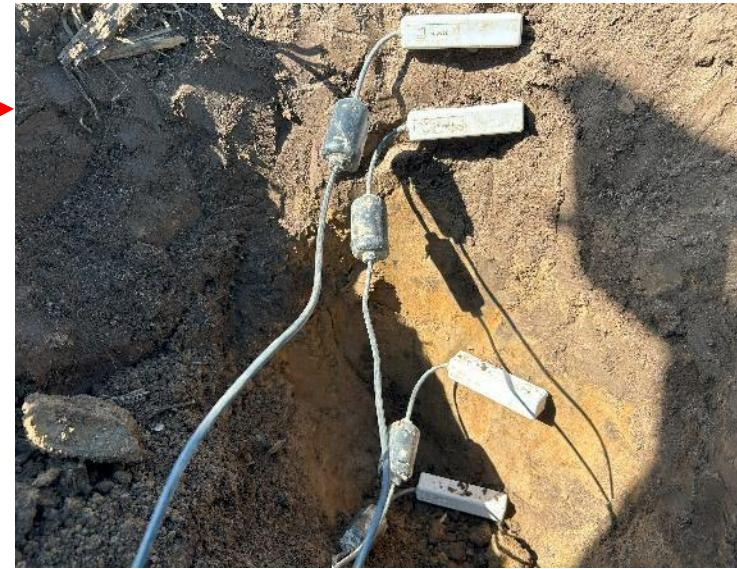
Installation de sondes à 4 profondeurs.
