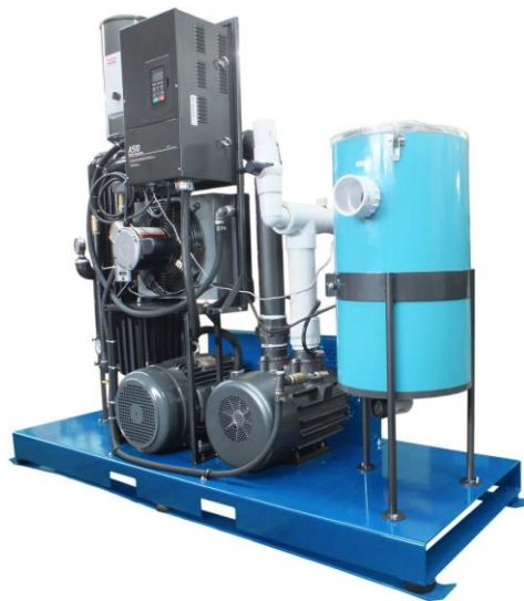
Figure 5.1. Pompe Airablo à palettes avec variateur de vitesse (Drive), récupérateur d'huile et radiateur (- 28,5 inHg)
