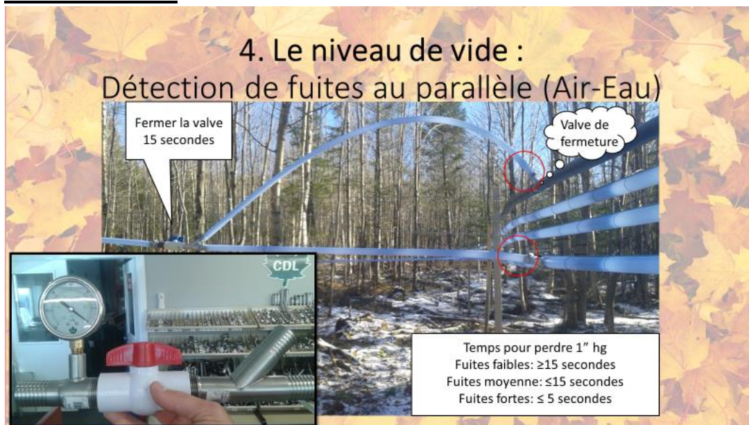
Figure 6.4. Détection de fuites, système air-eau
