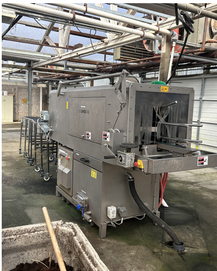
Nettoyage des plateaux à l'eau sous haute pression – Marque Limex
