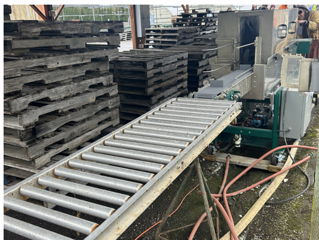
Nettoyage des plateaux à l'eau sous haute pression – Marque Pro-Line de Bouldin & Lawson
