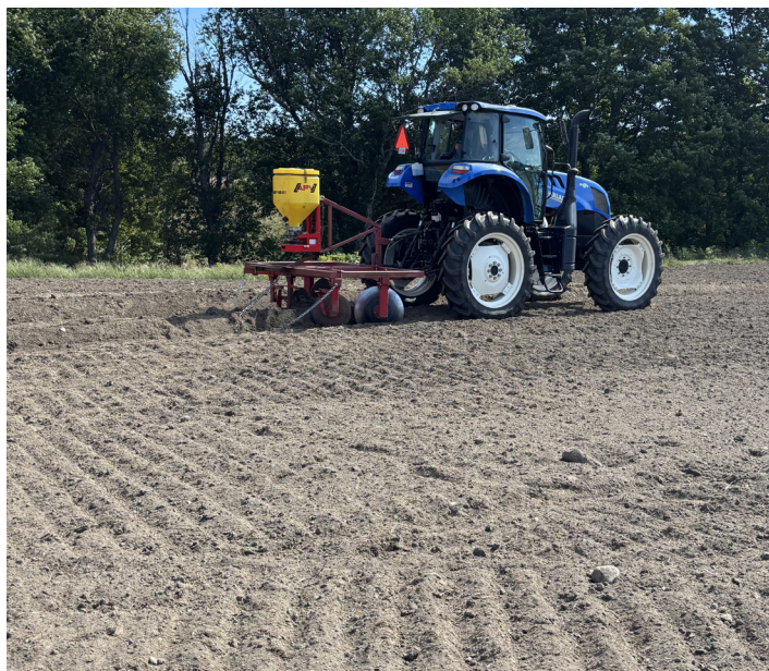
Billonneuse avec épandeur d'engrais intégré
