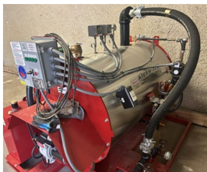
Générateur de vapeur portatif – Marque Sioux (Steam Flow)
