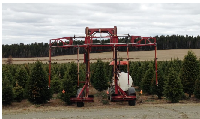
Rampe verticale multirangs pour l'application d'insecticides ou de fongicides
