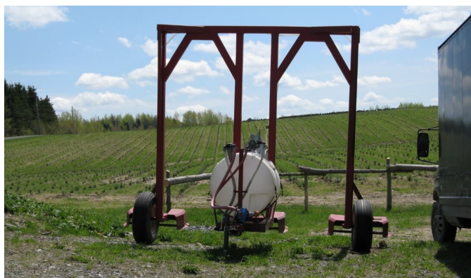
Rampe multirangs pour l'application d'herbicides
