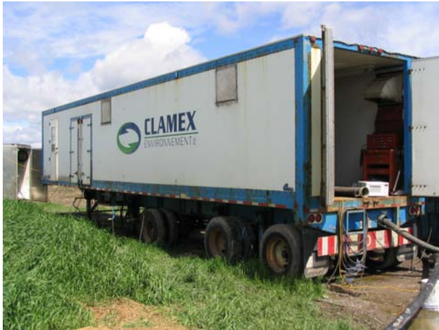
Unité mobile contenant la centrifugeuse
